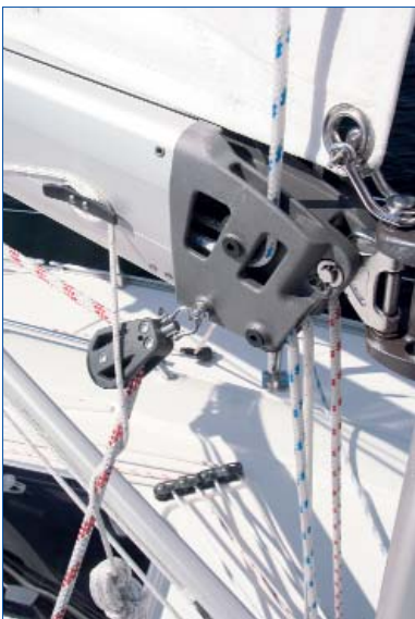
La bôme Selden intègre un système de prise de ris avec une bosse en continu pour l'amure et l'écoute. L'écoute de grand-voile circule sur la poulie au premier plan.
